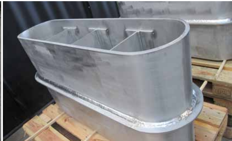
Wanddurchführung für Kernfusionsreaktor
